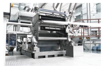
Fig. 3. Brückner film casting unit
