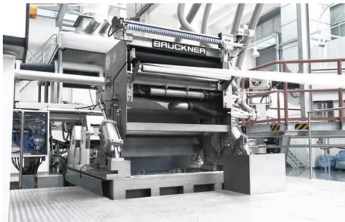
Fig. 3. Brückner film casting unit
